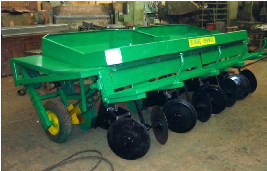
**Название разработки:** Картофелесажалка клоновая навесная четырехрядная
