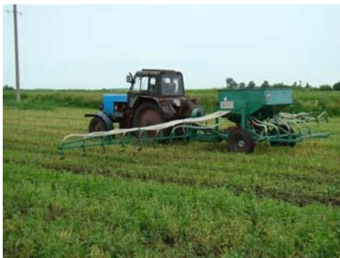
**Название разработки:** Многофункциональный агрегат для дробного внесения азотных удобрений в период вегетации растений
