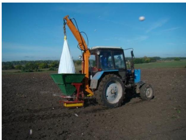
**Название разработки:** Самозагружающийся разбрасыватель твердых минеральных удобрений
