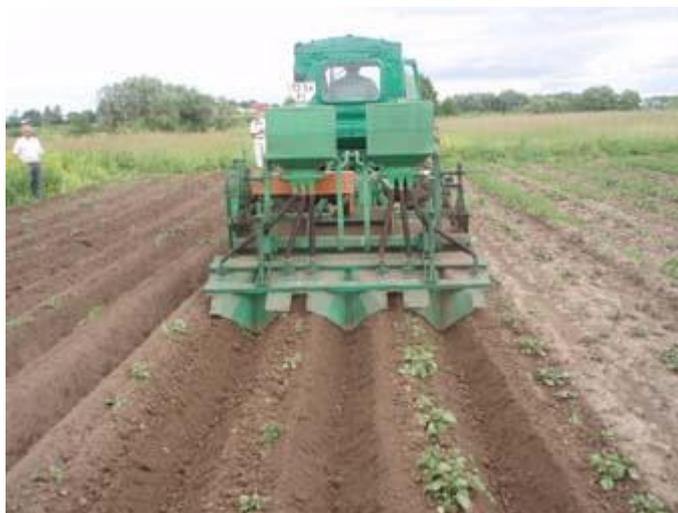
**Название разработки:** Удобритель-гребнеобразователь двухрядный для возделывания картофеля
