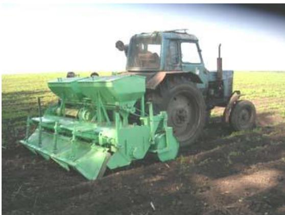
**Название разработки:** Удобритель-гребнеобразователь четырехрядный для возделывания картофеля с междурядьями 70 - 75 см
