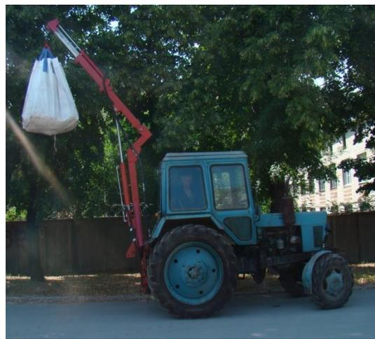
**Название разработки:** Тракторные навесные гидравлические подъемники
