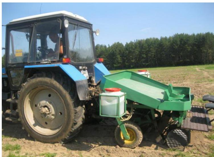
**Название разработки:** Картофелесажалка с технологическим адаптером для обработки защитно-стимулирующими препаратами
