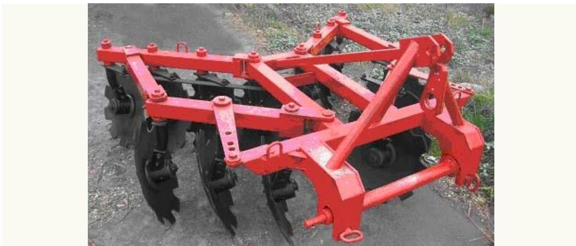
**Название разработки:** Борона дисковая для обработки почвы в ягодных кустарниках (с регулируемой шириной захвата)
